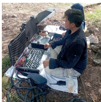
Gambar 1. Pengukuran Menggunakan Alat Geolistrik Geotitis GL-MD-300 48 Channel
