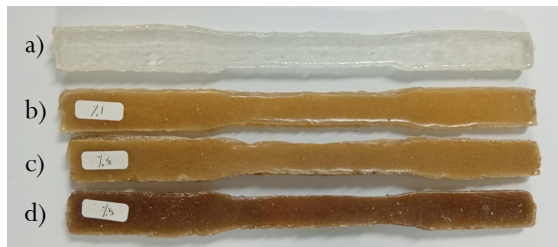
Gambar 3. Spresimen uji komposit dengan filler a) 0%, b) 1%, c) %3, dan d) 5%
