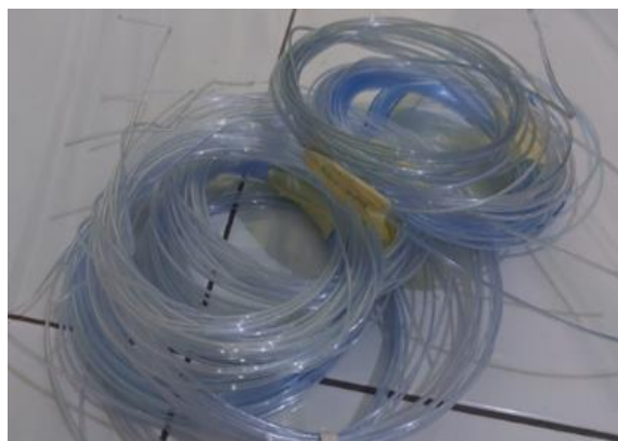
Gambar 12. Gulungan filament hasil Speed 3 (Kondisi Optimal) yang memperlihatkan konsistensi diameter, kejernihan tinggi, dan tidak adanya cacat permukaan ( sharkskin effect ).
