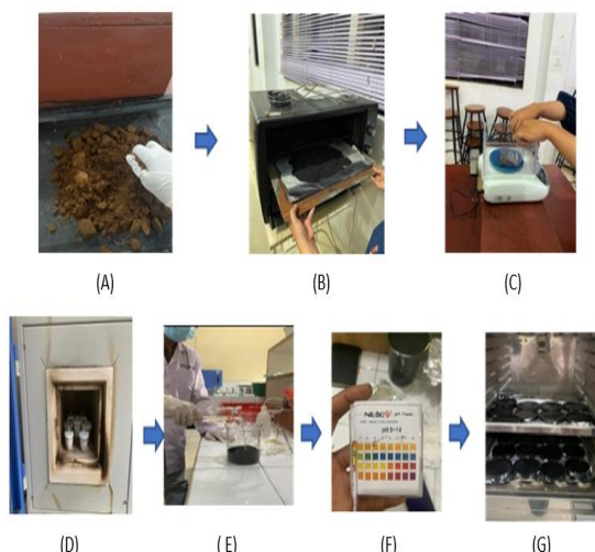
Gambar 1. Proses Pembuatan Adsorben dari Limbah Ampas Kopi; (a) Limbah Ampas Kopi; (b) Pengeringan; (c) Pengayakan; (d) Karbonisasi; (e) Acidifikasi; (f) Pengecekan pH; (g) Pengeringan
